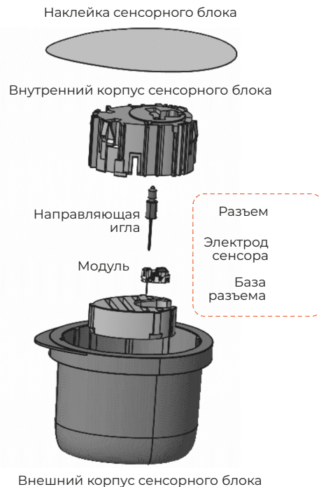
Рисунок 4 - Разобранный чертеж модуля сенсора
